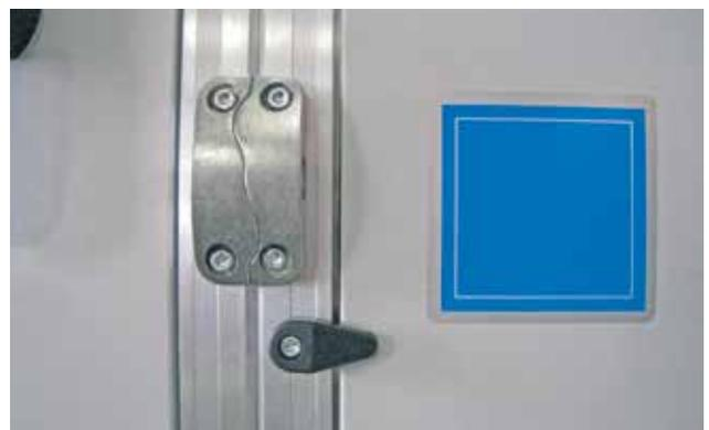
*Bild 19:* Nachdem Sie die Abschnitte zusammengezogen haben, verbinden Sie sie mit Hilfe der Exzenterklemmen, die am Profilrahmen angebracht sind. Die Exzenterklemmen sind sowohl an der vertikalen als auch an der horizontalen Seite entweder innen (Abbildung 20) oder außen (Abbildung 19) am Rahmen angebracht.
