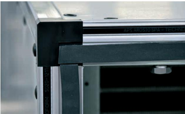
*Bild 15:* Das Dichtungsband muss an den Ecken überlappen. Bringen Sie beim Verbinden zweier Sektionen das Dichtungsband nur auf einer Sektion an.
