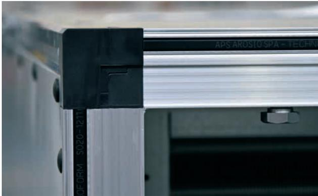
*Bild 14:* Kleben Sie vor dem Verbinden der Sektionen ein selbstklebendes EPDM-Gummidichtband mit einem Querschnitt von 20 x 8 mm (im Lieferumfang des Lüftungsgeräts enthalten) auf die Kontaktflächen (Gehäuserahmen).
