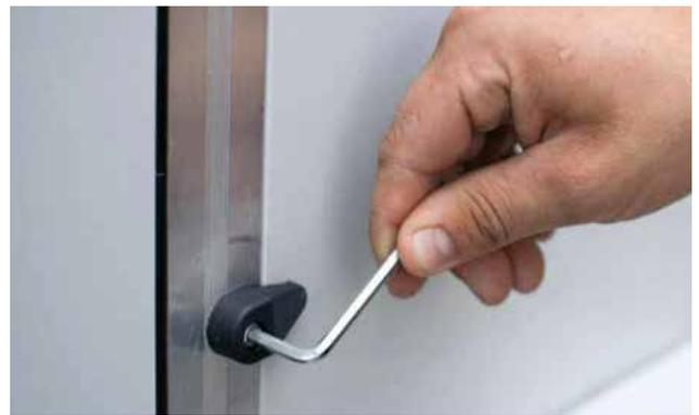
*Bild 22:* Die Überdrucktüren und Serviceabdeckungen sind mit Kunststoffriegeln am Gehäuse befestigt. Verwenden Sie zum Entfernen / Anbringen einen 4-mm-Inbus-Schlüssel..
