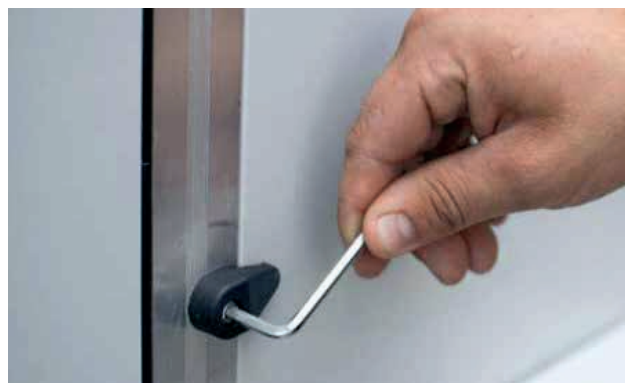
Рис. 22. Дверцы избыточного давления и съёмные двери крепятся к корпусу с помощью блокираторов. Для снятия и установки блокираторов используйте шестигранный ключ № 4.
