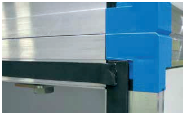
Рис. 15. По углам уплотнительная лента должна перекрываться. При соединении двух блоков наносите уплотнительную ленту только на один из блоков.
