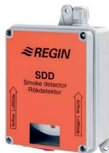
Slika 56: Detektor dima deluje kot optični detektor in ima vgrajen relejski vmesnik za alarm. V primeru aktivacije se naprava ustavi.
